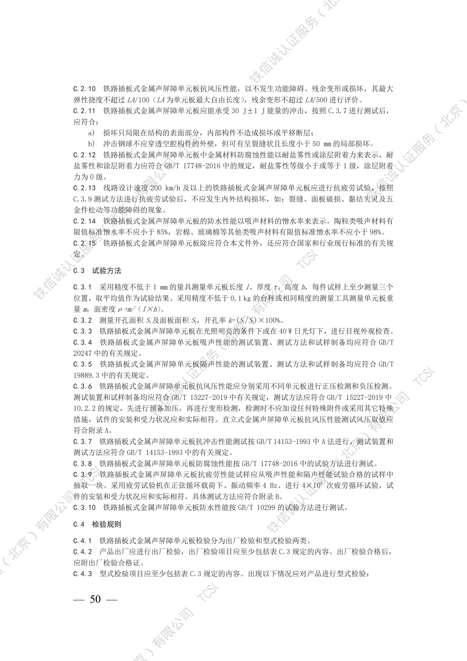
C. 2.10 铁路插板式金属声屏障单元板抗风压性能, 以不发生功能障碍、残余变形或损坏, 其最大弹性挠度不超过  $LA/100$  ( $LA$  为单元板最大自由长度), 残余变形不超过  $LA/500$  进行评价。
