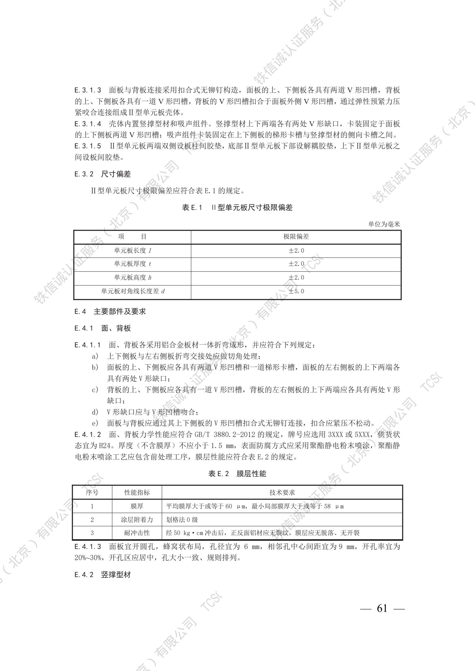
E. 3.1.3 面板与背板连接采用扣合式无铆钉构造,面板的上、下侧板各具有两道V形凹槽,背板的上、下侧板各具有一道V形凹槽,背板的V形凹槽扣合于面板外侧V形凹槽,通过弹性预紧力压紧咬合连接组成II型单元板壳体。
